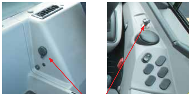
Электрическая розетка 12 В пост. тока
