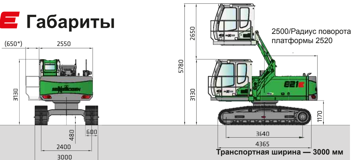
821R с ходовой частью R25/240 и кабиной типа E270 с гидравлическим подъемом
