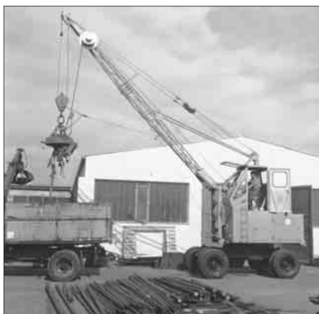
1962 год: Канатный экскаватор S833 с кабиной оператора с фиксированным подъемом
