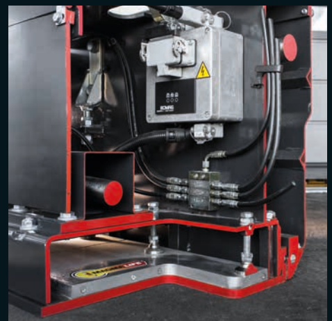
Удивительно просто: система нагрева с контролем нагревательных контуров.
