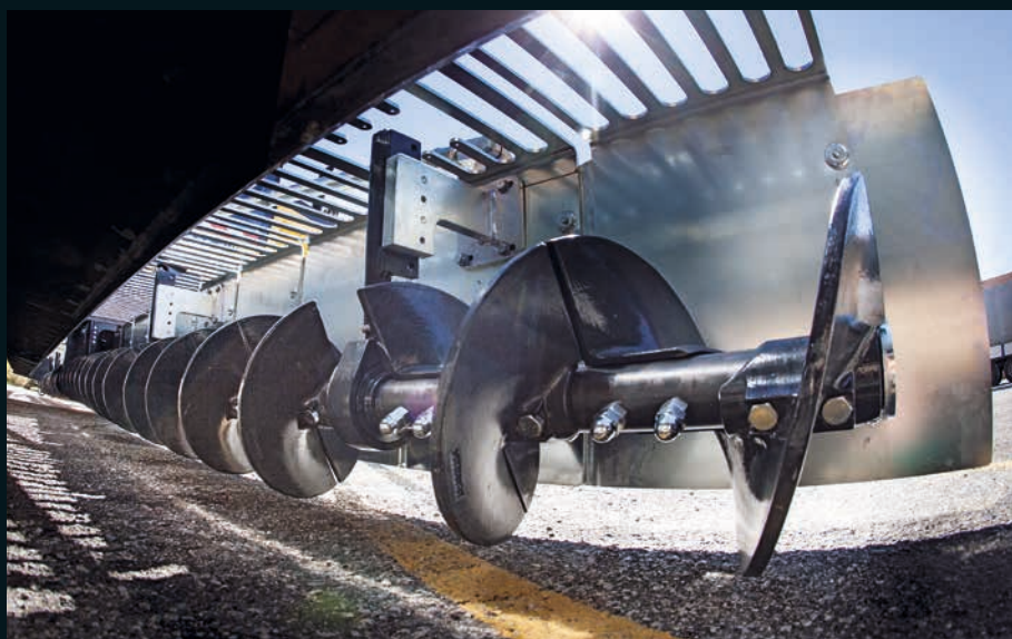
Оптимальное распределение материала: большой диаметр шнека.
