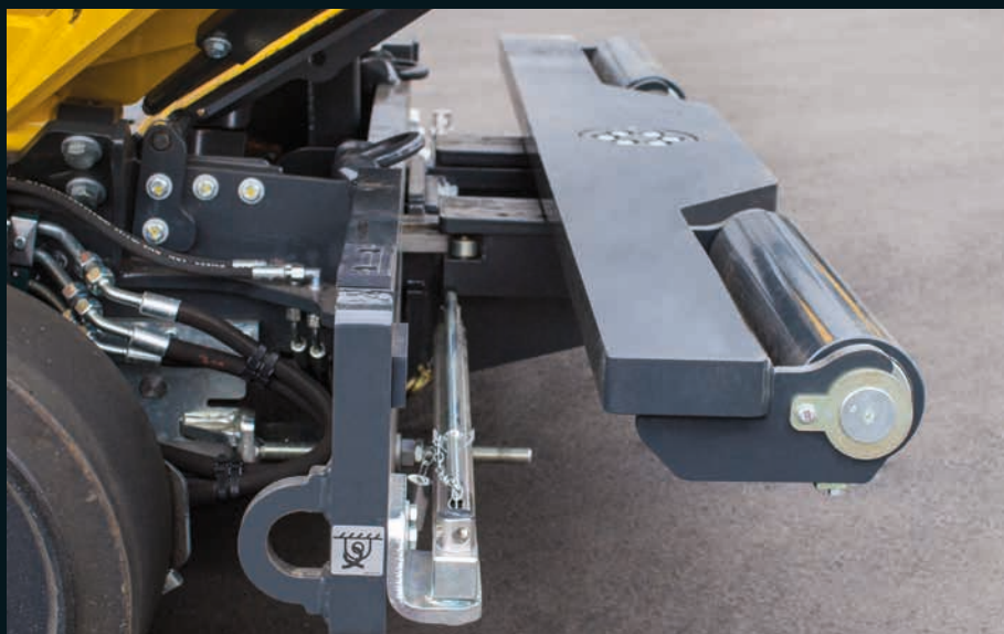
Подпружиненные сдвигаемые ролики: гидравлически регулируемые и с качающейся опорой.
