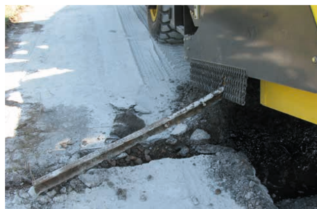
Гидравлическое предохранение от перегрузки позволяет избежать любых „сюрпризов“.
