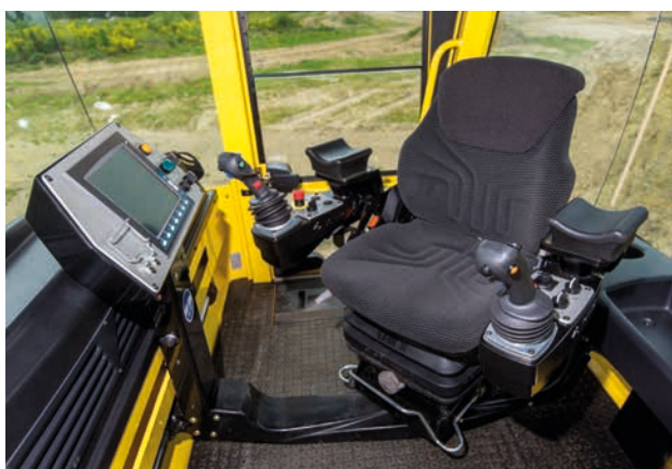
Дисплей предназначен исключительно для индикации и регулировки дозирующих систем.
