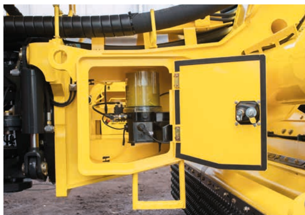
Серийно в RS 500: централизованная смазочная система.
