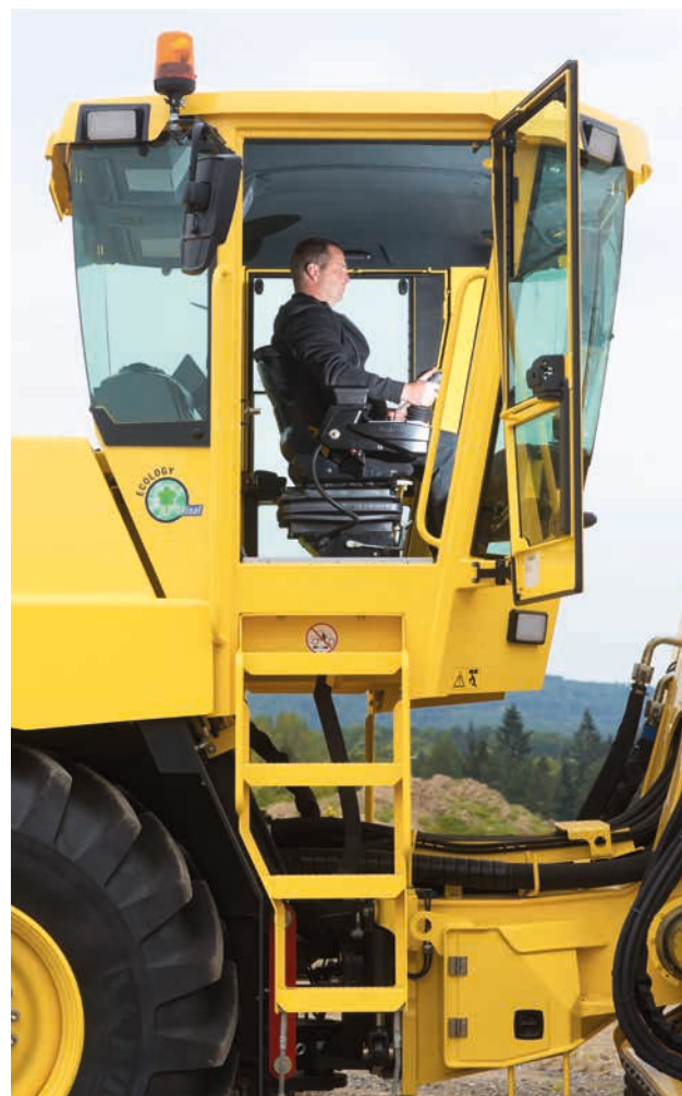
Наилучший обзор даже при движении задним ходом с вращающимся на 270 градусов сиденьем.
