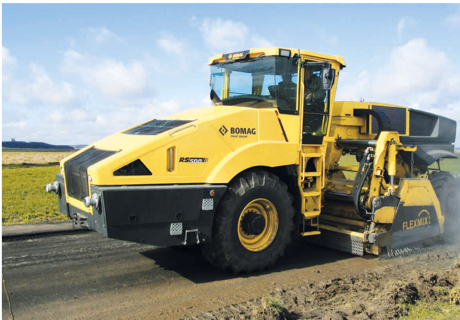
Встречное фрезерование на 8 см асфальтированной дороги.
