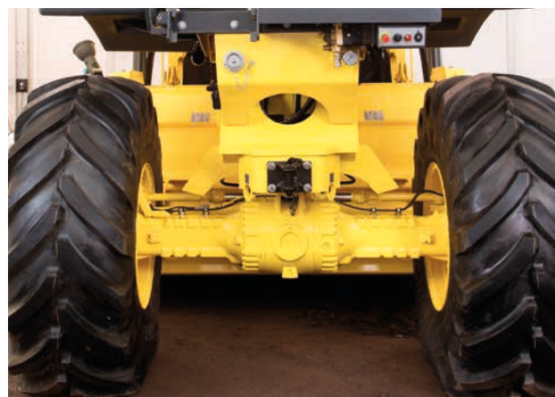
Ведущий мост с качающимися полуосями +/-15° с блокировкой дифференциала (RS 460).
