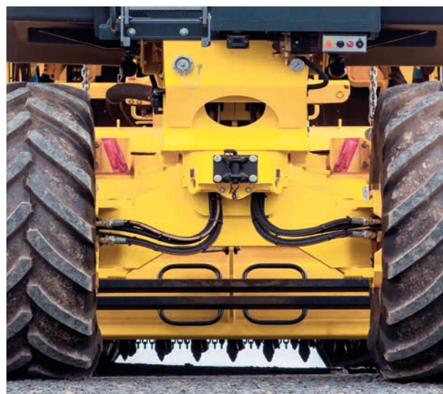
Задний мост с мощными независимыми приводами (RS 500).
