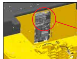
Включатель электрического топливоподкачивающего насоса
