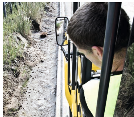
Створчатое окно и сдвигающееся сиденье обеспечивают комфортную работу.
