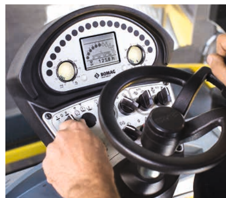
Панель управления всегда находится перед глазами оператора. Управление с помощью выключателей происходит быстро и интуитивно.
