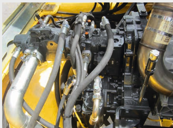
Гидравлический привод колес с «блоком ограничения нагрузки» (управление скоростью в зависимости от нагрузки) (BC 473).
