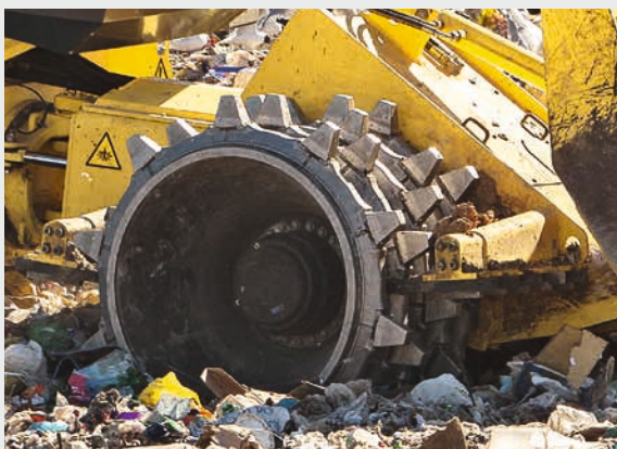
Скребки гарантируют чистоту колес и высокую степень уплотнения.
