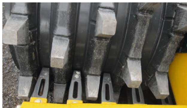
Скребки с возможностью регулирования для бесперебойной эксплуатации.
