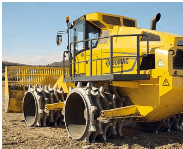
Эта площадка обеспечивает доступ к месту технического обслуживания.
