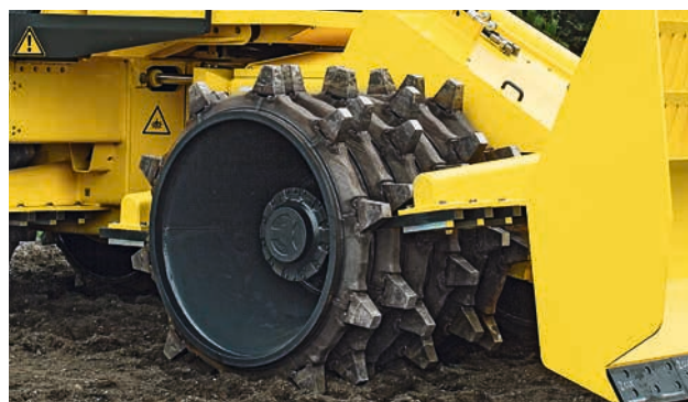
Сварные колесные диски с внутренним конусом с обеих сторон для оптимальной устойчивости (премиум-класс).
