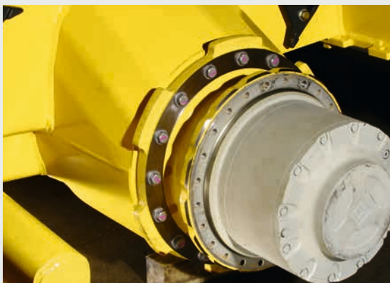
Две независимые тормозные системы (гидростатическая система в качестве рабочего тормоза, многодисковый тормоз в качестве стояночного тормоза).
