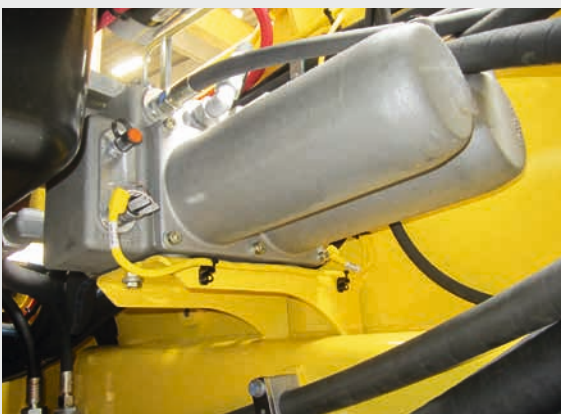
Электронный контроль системы фильтров очистки противотоком гидравлики.
