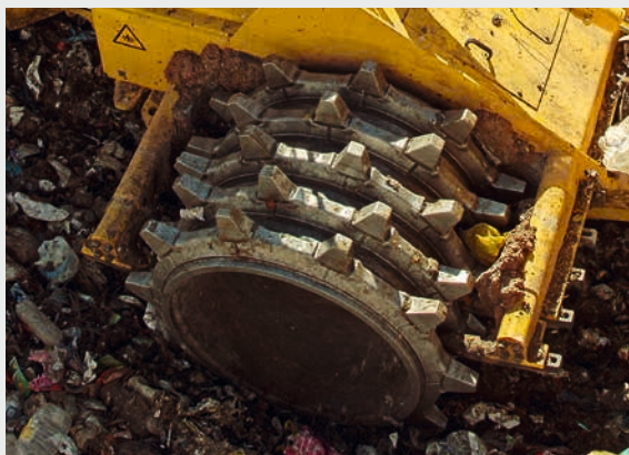
Чистые колеса с эффективными скребками (оптимальное уплотнение).
