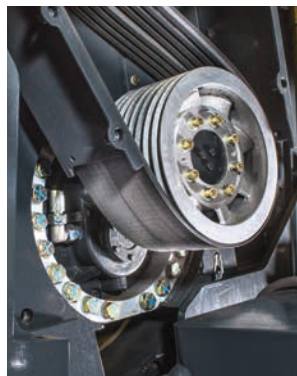
Редуктор привода барабана фрезы благодаря внешнему охлаждению и фильтрации масла чрезвычайно надежен.
