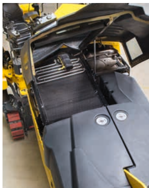
Внешние системы охлаждения установлены так, что они легко доступны, безопасны и удобны для обслуживания.
