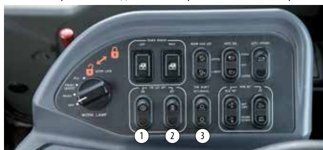
1: Выключатель коробки передач 2: Регулятор давления отключения коробки передач 3: Переключатель скоростного диапазона
