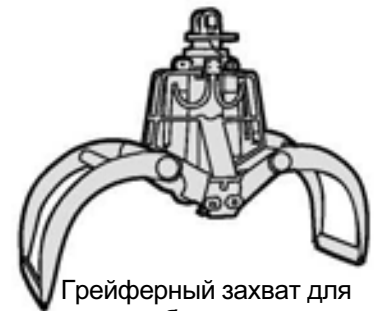
Перегрузочный грейфер Rehandling Grab
