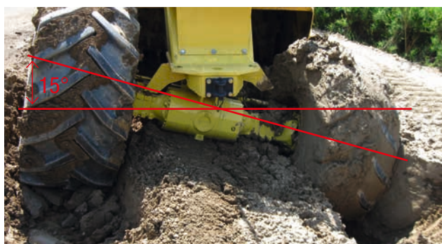
Ведущий мост с углом качания \pm 15^\circ .
