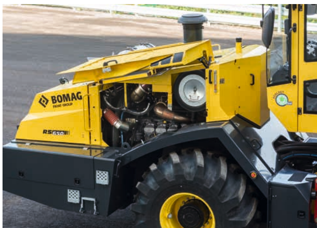
Все точки обслуживания легко доступны: водяной фильтр, AdBlue, централизованная система смазки.
