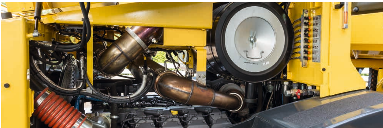
TIER 4 final с двойной системой SCR.
