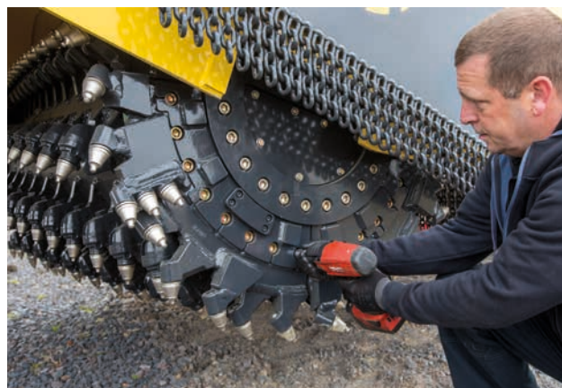
Смена краевых сегментов без необходимости демонтажа ротора.
