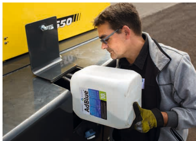
Все точки обслуживания легко доступны: водяной фильтр, AdBlue, централизованная система смазки.
