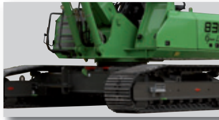
Unterwagen - größeres Abstützquadrat mit erhöhter Standfestigkeit Undercarriage - larger outrigger area with increased stability
