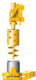
Бурение штангой келли с обсадными трубами Погружение обсадных труб посредством обсадного стола Cased Kelly Drilling Casing Installation with Oscillator
