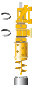
Бурение штангой келли с обсадными трубами Установка обсадных труб при помощи BTM Cased Kelly Drilling Casing Installation with BTM
