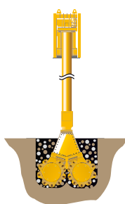
CSM Фреза для смешивания грунта Cutter Soil Mixing
