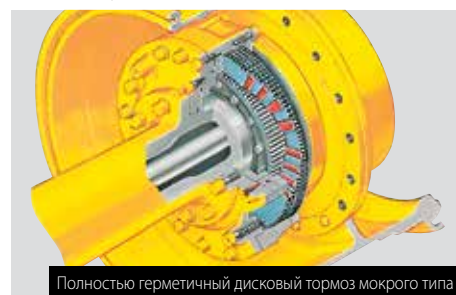
Полностью герметичный дисковый тормоз мокрого типа
