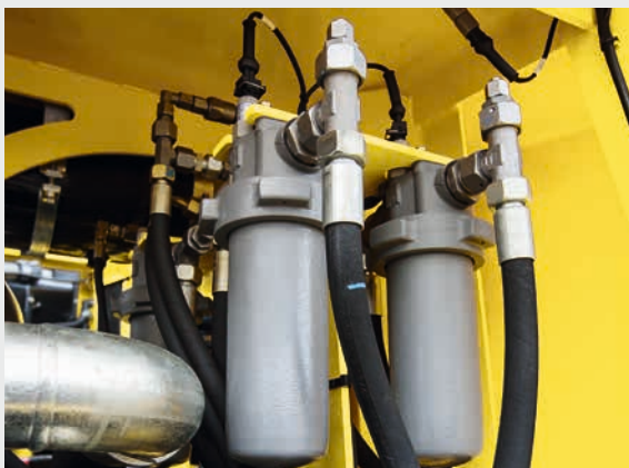
Сторона нагнетания системы фильтров гидравлики.
