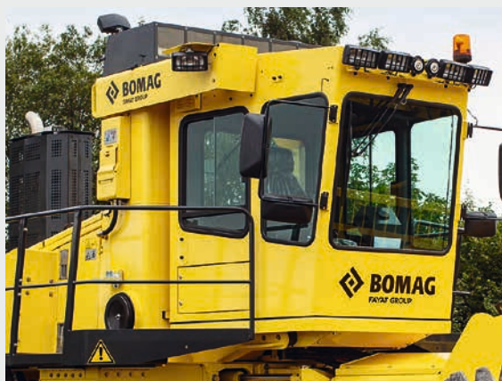
Конструкция кабины соответствует предписаниям ROPS и FOPS.
