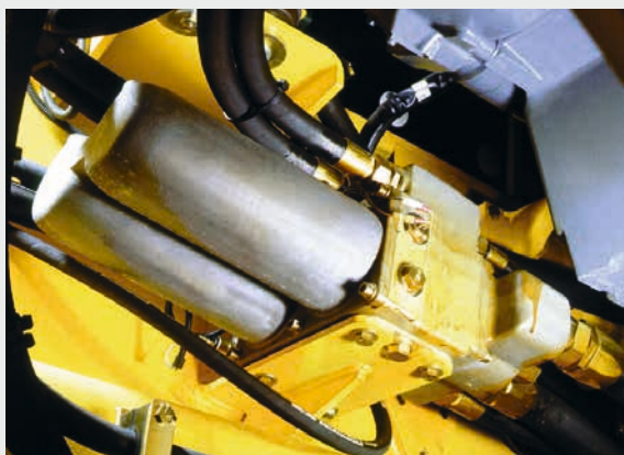
Электронный контроль системы фильтров очистки противотоком гидравлики.
