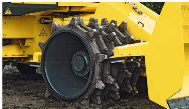
Сварные колесные диски с внутренним конусом с обеих сторон для оптимальной устойчивости.
