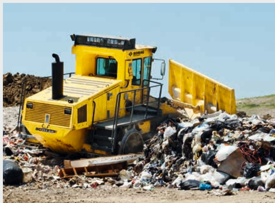
Оптимальное уплотнение благодаря качающемуся сочленению, которое обеспечивает хорошее распределение нагрузки между уплотнительными колесами
