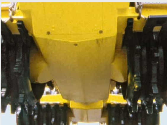
Рама с закрытыми сегментами для наилучшей защиты всех компонентов и предотвращения проникновения материалов – отсутствие опасности воспламенения горячих компонентов.
