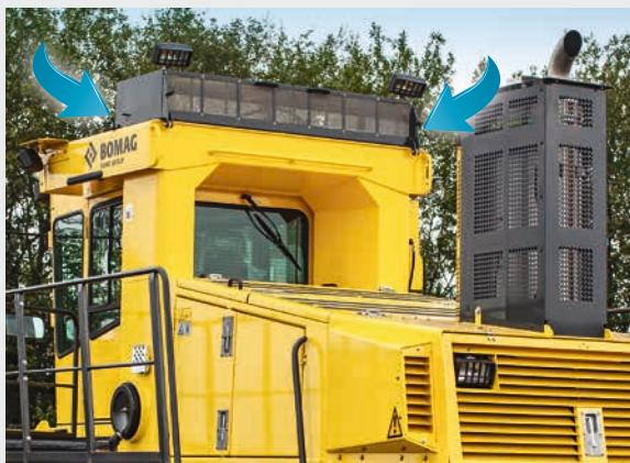
Всасывание на большой высоте воздуха для охлаждения и воздуха, поступающего в зону горения, с минимальным содержанием пыли.
