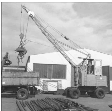
1962 год: модель S833 с канатным приводом и повышенным расположением кабины водителя
